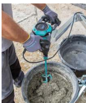
Le mélangeur peut être déplacé dans toutes les directions. Il atteint tous les points du seau.
